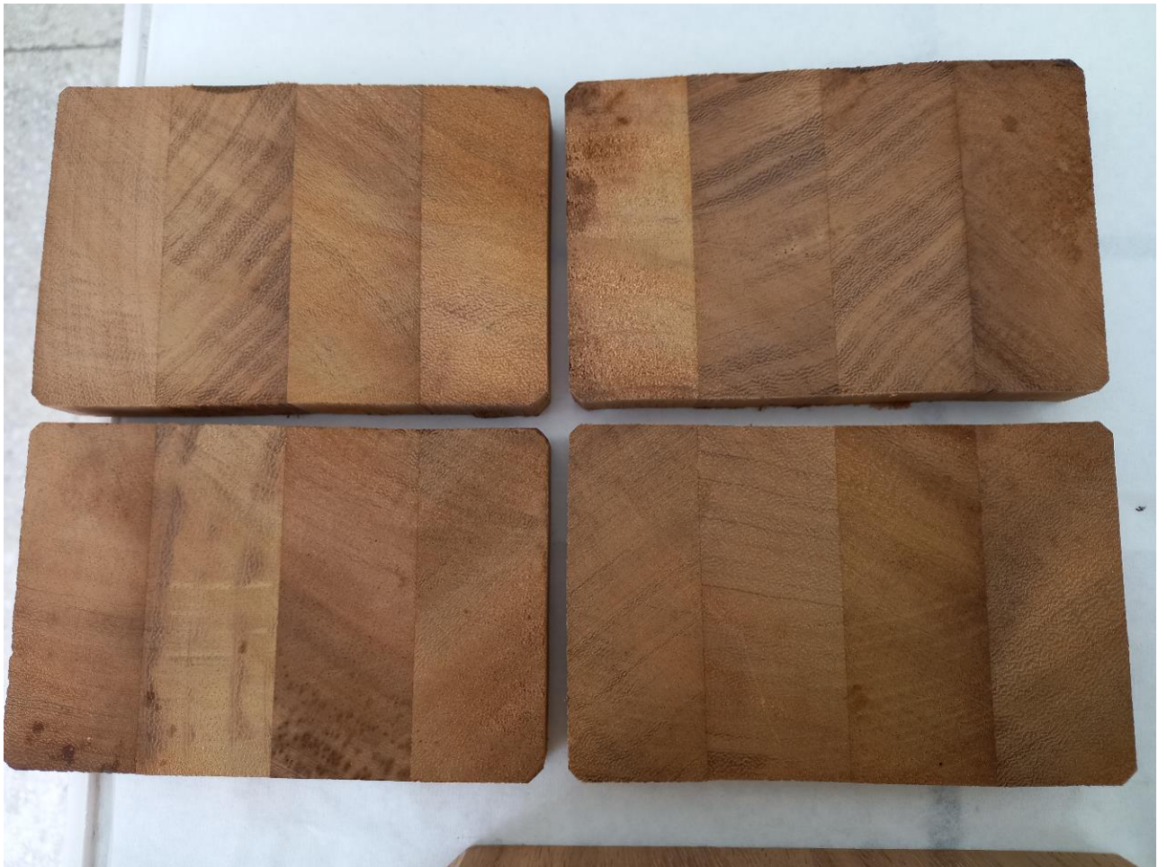
Εικ. 19. Εμφάνιση των εγκάρσιων όψεων των τετρακολλητών δοκίδων μετά τη δοκιμή με τη χύτρα. Φαίνονται σε πολύ καλή κατάσταση.
