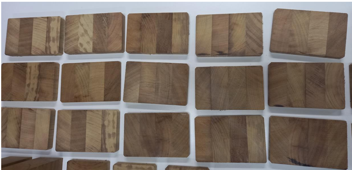
Εικ. 3. Μερική άποψη από δοκίμια πάχους 20 mm από τις επικολλημένες ξύλινες δοκίδες (διατομής 100x150 mm) που στάλθηκαν για ταυτοποίηση.
