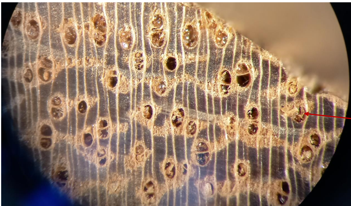
Εικ. 9. Μικροσκοπική εμφάνιση της εγκάρσιας τομής ενός δοκιμίου (διακρίνονται: αραιή διάταξη των αγγείων, πολλοί κρύσταλλοι, τυλώσεις φαίνονται σε αρκετούς πόρους, παχιές ακτίνες, και εντονότατο ταινιοειδές παρέγχυμα, ακανόνιστης διάταξης, ο αριθμός ακτίνων είναι μέτριος γενικά, 6-8/1 εφραπτ. mm).
