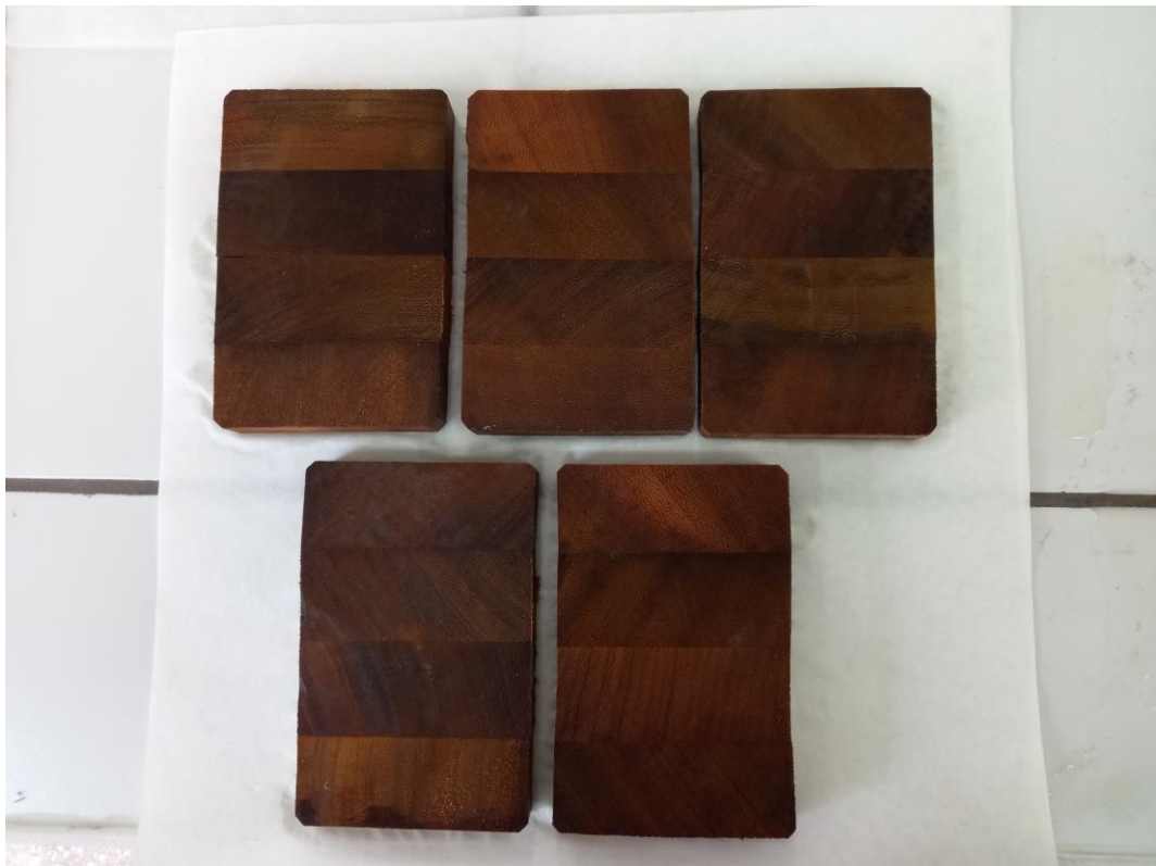
Εικ. 15. Μετά τη δοκιμή του βρασμού στη χύτρα (σημ. δοκίμια των δοκίδων).
