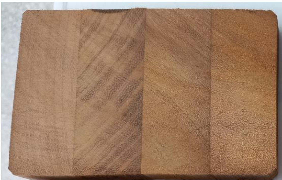
Εικ. 20. Κοντινό πλάνο από ένα (1) συγκολλητό στοιχείο δοκίδας – Σε άριστη κατάσταση.
