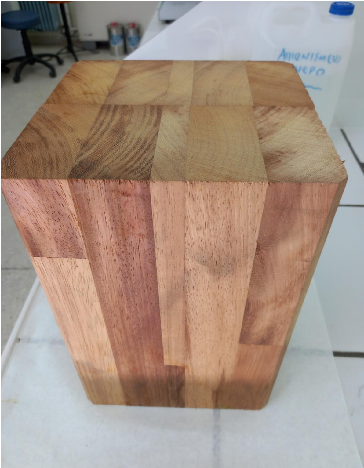
Εικ. 16. Άριστη εμφάνιση όλης της επικολλητής ξύλινης δοκού, μετά την ξήρανσή της. Δεν διακρίνονται σφάλματα ή αποκολλήσεις ή τυχόν ανοίγματα. Διατηρείται η όλη συνεκτικότητα αυτής.
