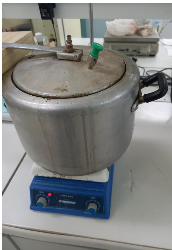
Εικ. 13. Η χύτρα που χρησιμοποιήθηκε (σημ. τα δοκίμια από τις ξύλινες δοκίδες σε φάση βρασμού του ύδατος μέσα στο εν λόγω κλειστό σύστημα). Η καταπόνηση των δεσμών είναι δριμεία.
