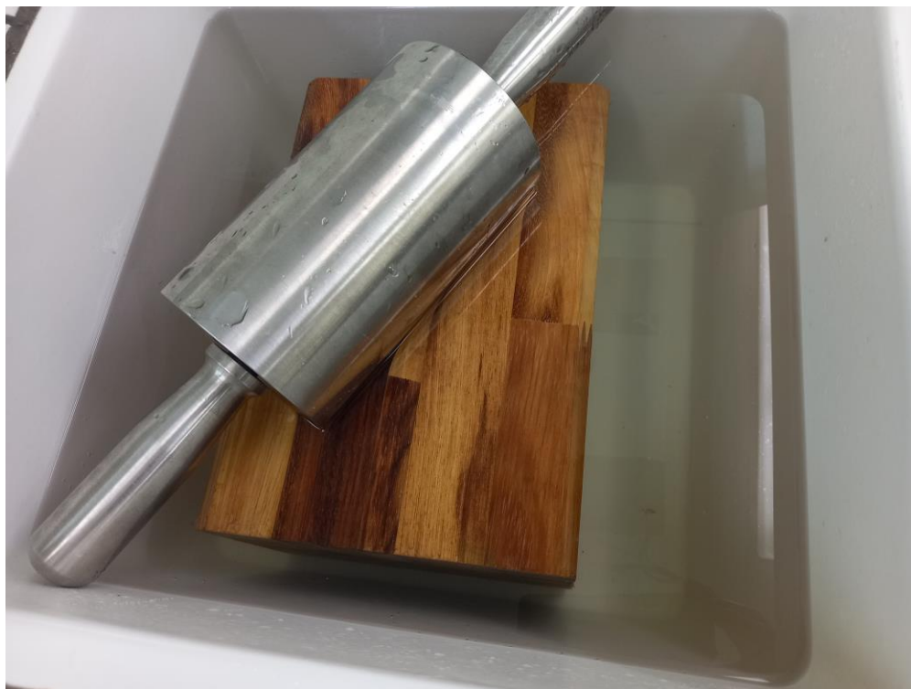
Εικ. 10. Η επικολλητή ξύλινη δοκός υφίσταται παρατεταμένη διόγκωση μέσα σε λουτρό ύδατος.
