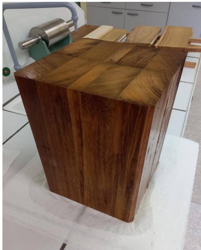
Εικ. 11. Μετά από 24 ώρες διόγκωσης σε νερό, η δοκός έχει απομακρυνθεί από το λουτρό.
