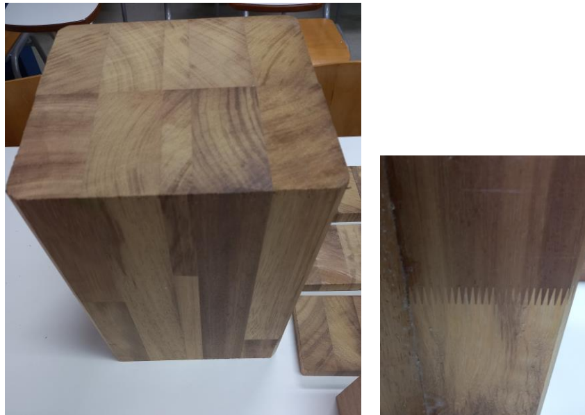
Εικ. 2. Άποψη από την ξύλινο δοκό (διατομής 200x200 mm) που στάλθηκε. Αποτελείται από δέκα (10) στοιχεία, επικολλημένα, και φέρει δακτυλοειδείς συνδέσεις (finger-joints).
