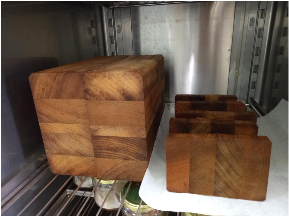
Εικ. 14. Μετά το πέρας των δοκιμών, τα δείγματα έχουν εισαχθεί σε θάλαμο κλιματισμού. Στη συνέχεια έλαβε χώρα η ξήρανση όλων των ήδη καταπονηθέντων δοκιμών ξυλείας.
