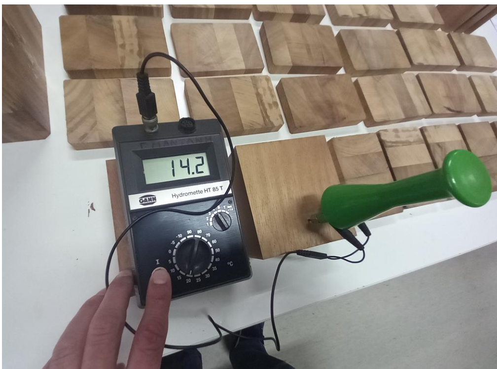
Εικ. 5. Άποψη από μέτρηση της περιεχόμενης υγρασίας σε ένα δοκίμιο με το ηλ. υγρόμετρο.
