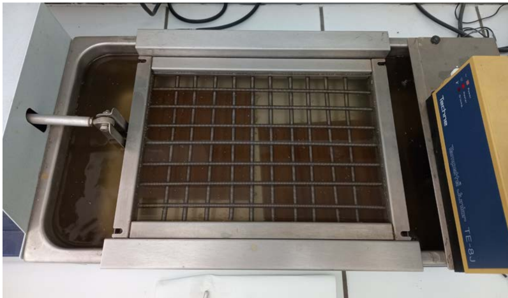
Εικ. 5. Τα δοκίμια HPL κατά τη δοκιμή των 48 ωρών σε θερμαινόμενο υδατόλουτρο.
