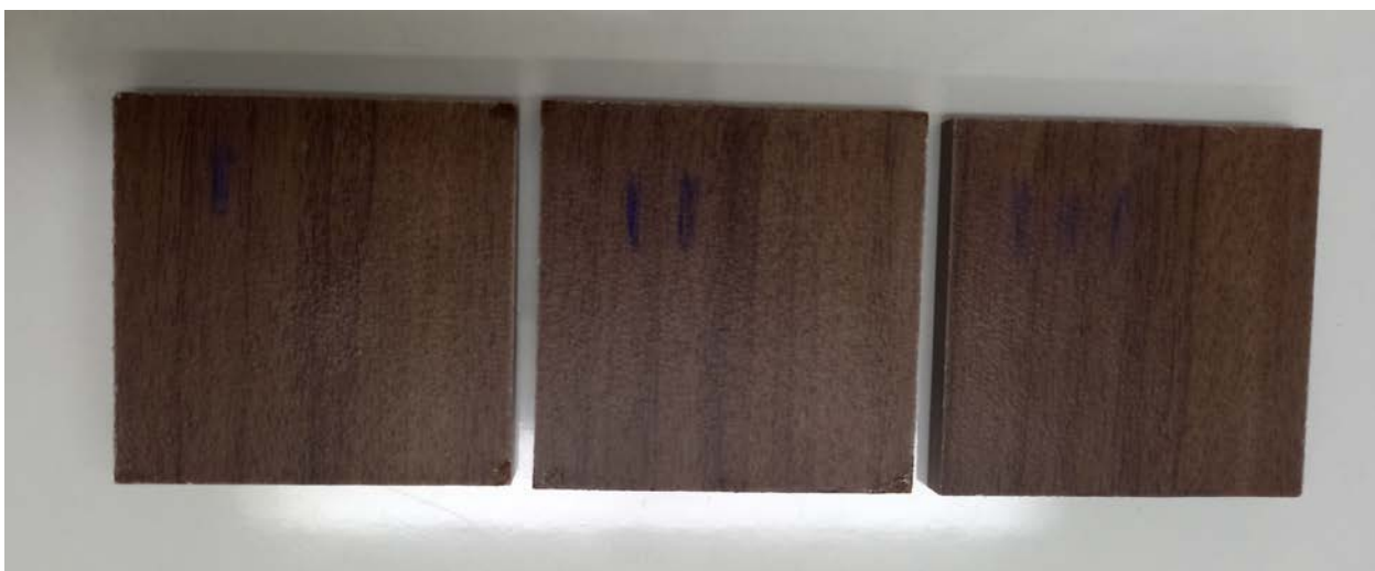
Εικ. 4. Εξωτερική εμφάνιση των δοκιμών HPL ( Greenlam ) μετά από το τεστ βρασμού.
