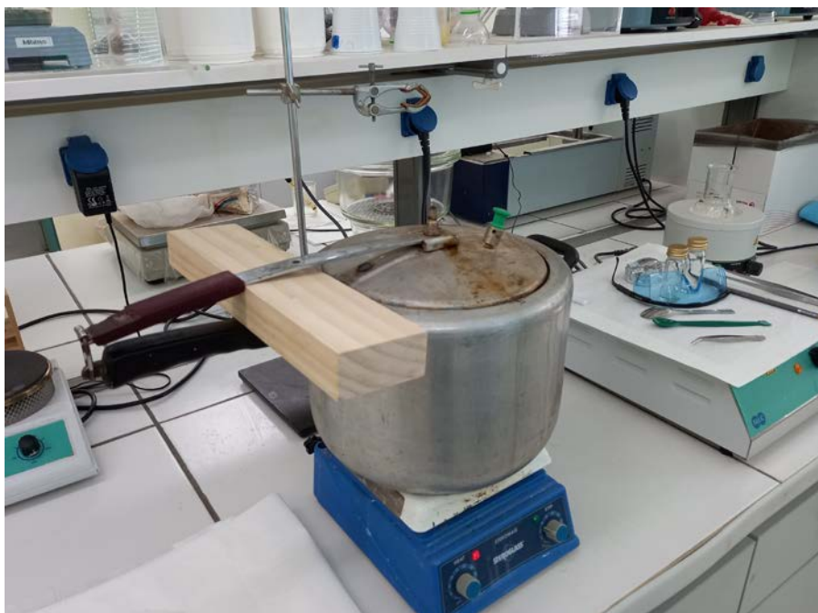
Εικ. 3. Άποψη από τη δοκιμή του προϊόντος Greenlam σε βράσιμο για 2 ώρες.
