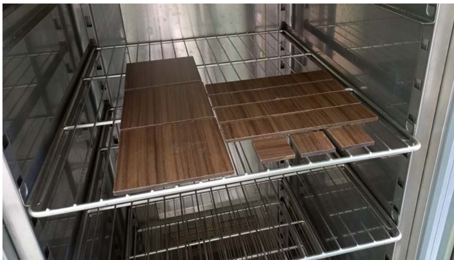
Εικ. 2. Τα υπό δοκιμή δείγματα HPL μέσα στον θάλαμο κλιματισμού.
