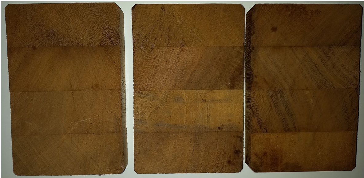
Εικ. 10. Δοκιμή βρασμού σε νερό - φωτογραφίες από την εγκάρσια τομή (σκόρο) σε τρία (3) δείγματα από τις δοκίδες, μετά από την ξήρανσή τους (= σχεδόν μηδενικές αποκολλήσεις στις συνδέσεις).
