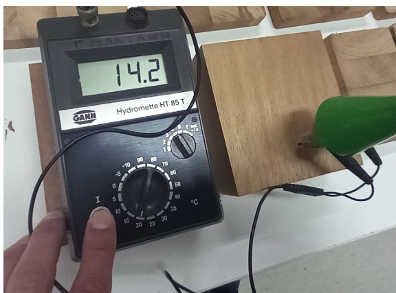
Εικ. 4. Μέτρηση της περιεχόμενης υγρασίας του ξύλου με ηλεκτρικό υγρόμετρο.
