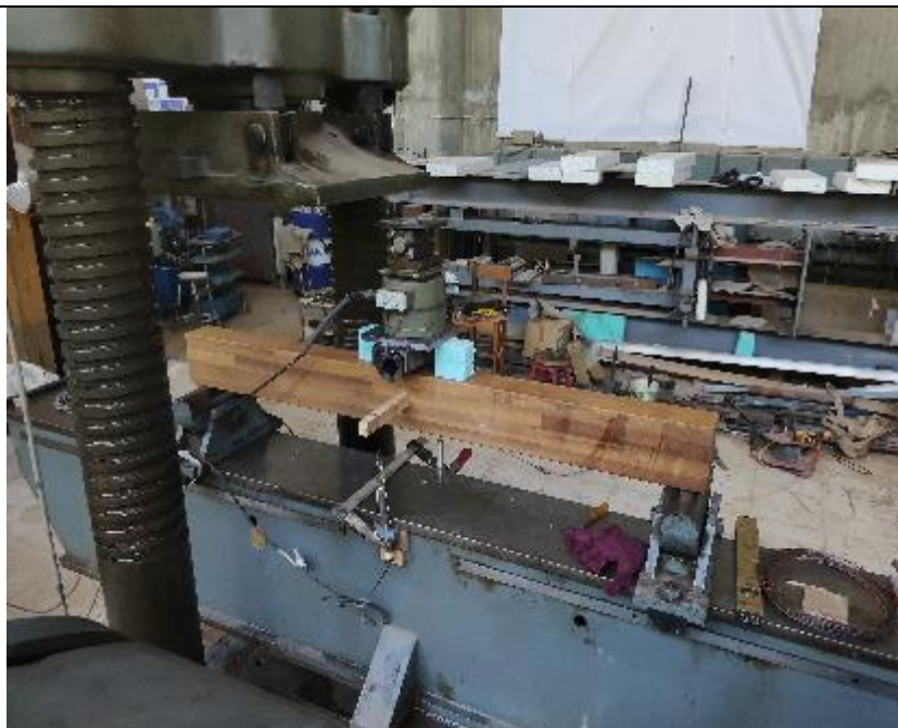
Εικόνα 1: Φωτογραφική απεικόνιση της διάταξης για τον έλεγχο κάμψης τριών σημείων.
