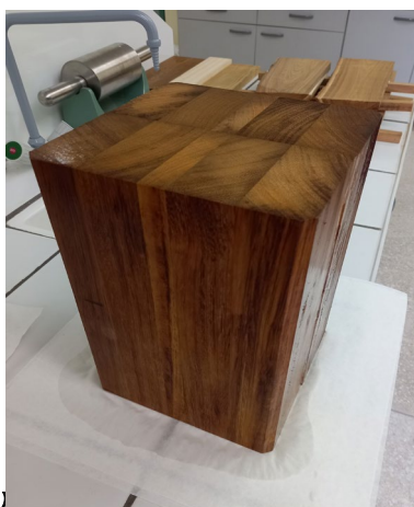
Εικ. 9A, 9B. Δείγμα επικολλητής δοκού μετά το βράσιμο (A), και μετά την ξήρανση (B).
