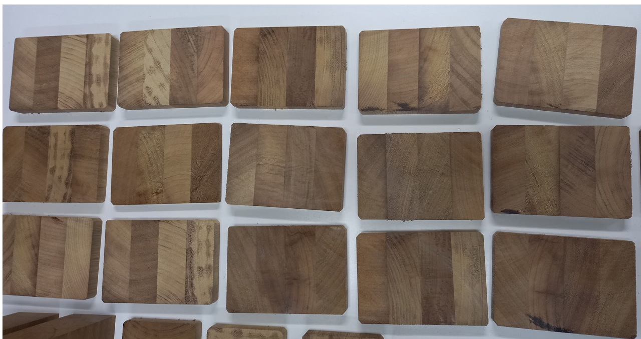
Εικ. 3. Μερική άποψη από τις δοκίμια από επικολλημένες ξύλινες δοκίδες (διατομής 100x150 mm) που στάλθηκαν για τον έλεγχο ποιότητας. Αποτελούνται από 4 επικολλημένα στοιχεία.
