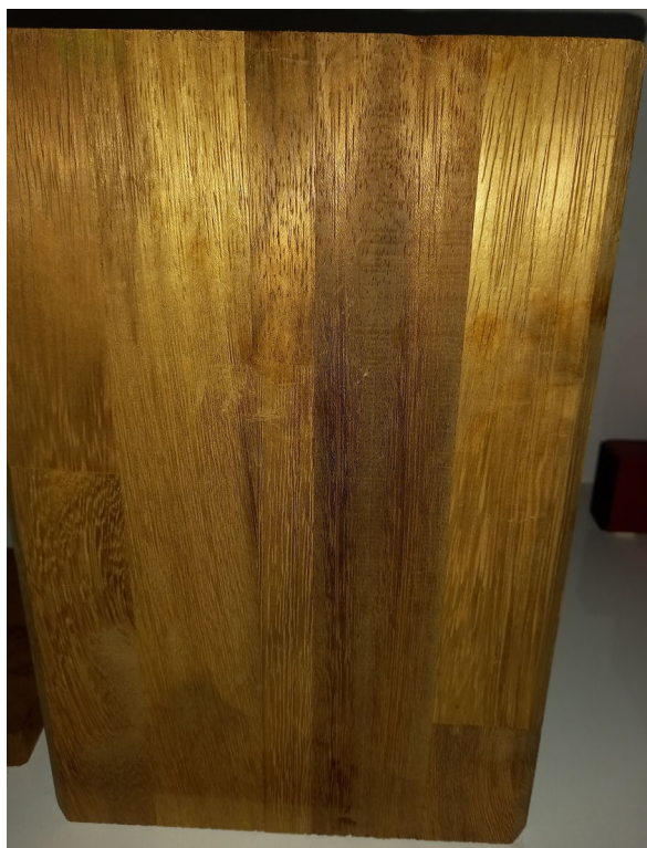
Εικ. 2Α, 2Β. Άποψη από τυχαία ξύλινο δοκό (διατομής 200x200 mm) που στάλθηκε. Αποτελείται από δέκα (10) επικολλημένα ξύλινα στοιχεία, και φέρει δακτυλοειδείς συνδέσεις (finger-joints) μήκους 12 mm.
