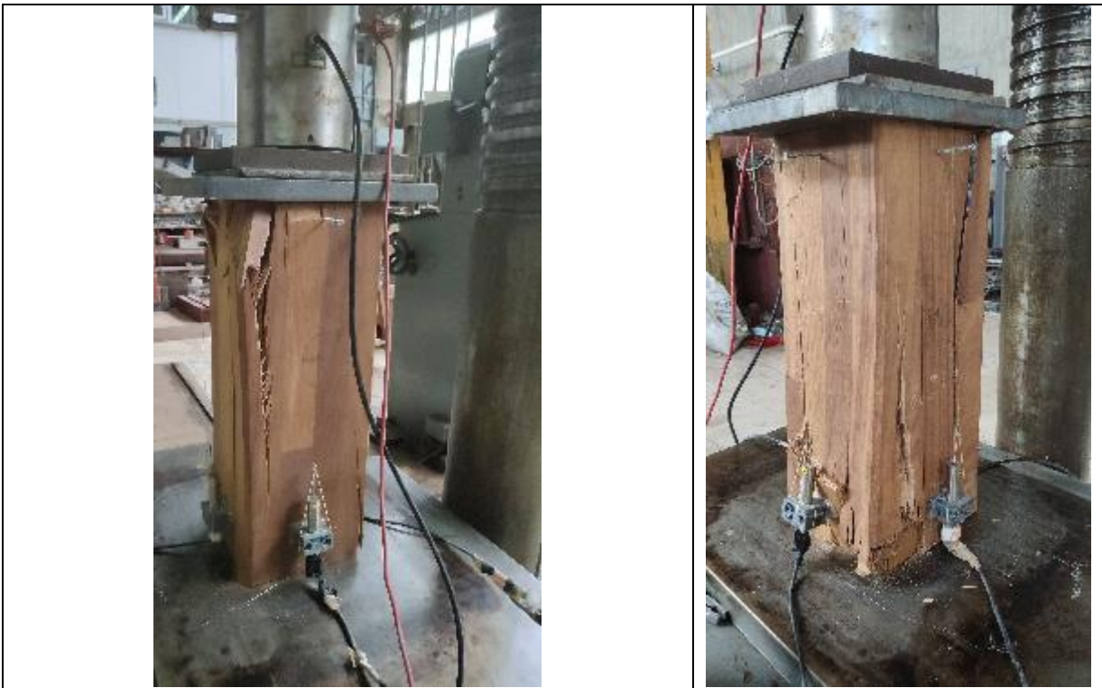
Εικόνα 5: Φωτογραφική απεικόνιση της αστοχίας για τα δοκίμια 1 και 2.
