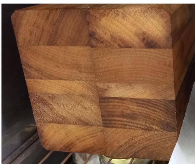
Εικ. 9A, 9B. Δείγμα επικολλητής δοκού μετά το βράσιμο (A), και μετά την ξήρανση (B).
