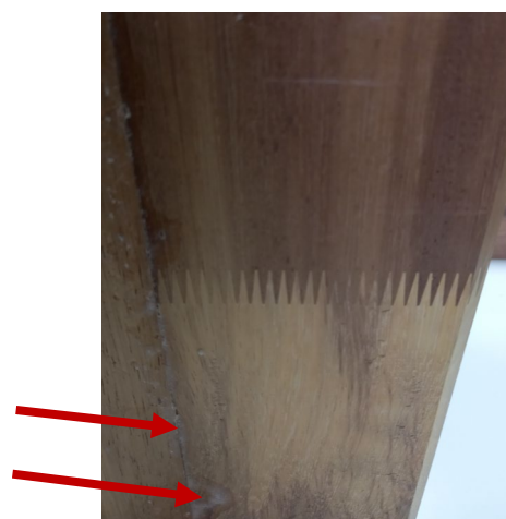
Εικ. 8. Συγκολλητική ουσία που έχει «εκχυλισθεί» από τις ενώσεις των ξύλων. Έγινε συλλογή της και αναλύθηκε στο εργαστήριο για εύρεση του τύπου της κόλλας.
