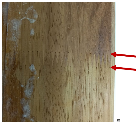
Εικ. 2Α, 2Β. Άποψη από τυχαία ξύλινο δοκό (διατομής 200x200 mm) που στάλθηκε. Αποτελείται από δέκα (10) επικολλημένα ξύλινα στοιχεία, και φέρει δακτυλοειδείς συνδέσεις (finger-joints) μήκους 12 mm.
