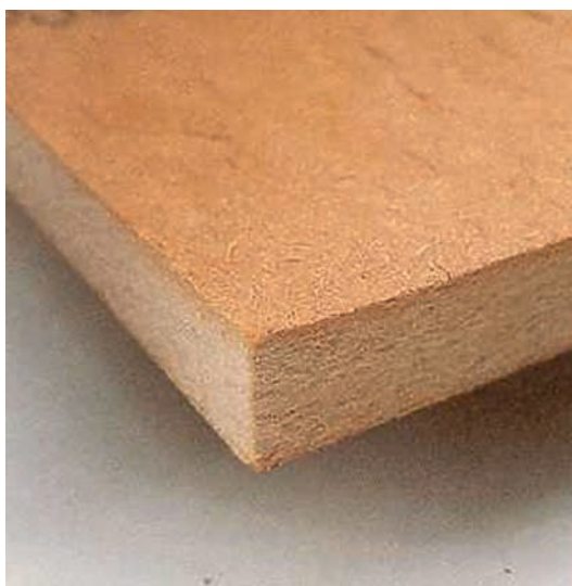
Εικ. 2.6 Θερμομονωτική ινοπλάκα από ίνες ξύλου
