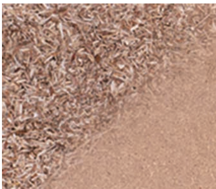
Εικ. 11.4 Ψεκασμός συγκολλητικής ουσίας στα ξυλοτεμαχίδια
