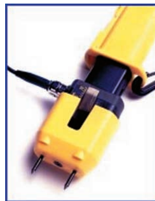
Εικ. 2.12 Ηλεκτρικό υγρόμετρο για μέτρηση υγρασίας
