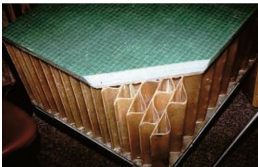
Εικ. 12.5 Μονωτικά προϊόντα με κυψέλη από χαρτί ή διογκωμένο πολυστυρόλιο
